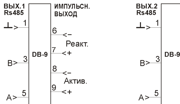
Рисунок Б.9. Расположение выводов ПЦ6806-17
