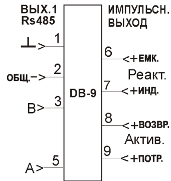
Рисунок Б.7. Расположение выводов ПЦ6806-03
