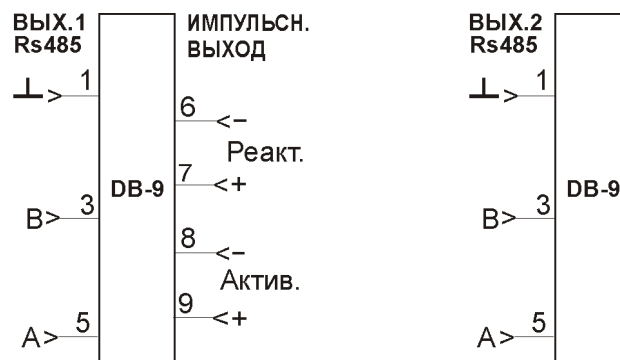
Рисунок Б.8. Расположение выводов ПЦ6806-03М
