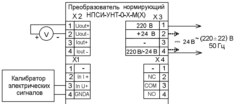
Рисунок А.6.3.1.1 – Подключение преобразователей НПСИ-УНТ-0-Х-М0 и НПСИ-УНТ-0-Х-М1 для проведения поверки: вход напряжение от 0 до 10 В, выход унифицированный сигнал напряжения от 0 до 10 В
