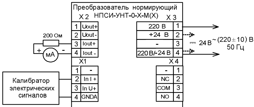
Рисунок А.6.3.3.1 – Подключение преобразователей всех модификаций НПСИ-УНТ-0-Х-М(Х) для проведения поверки: вход постоянный ток от 0 до 20 мА, выход унифицированный сигнал постоянного тока от 0 до 20 мА
