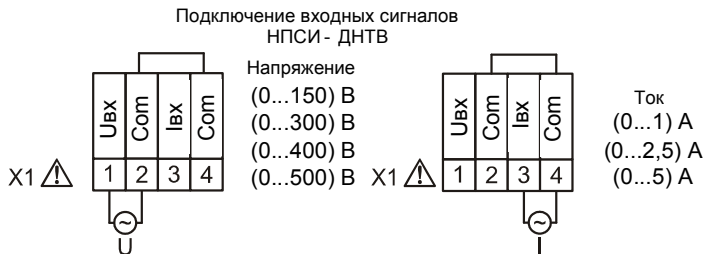
Рисунок 7а – Подключение входных сигналов к НПСИ-ДНТВ
