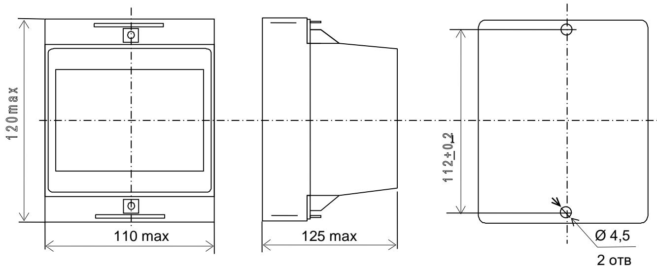
Рисунок А.1 – Габаритные и установочные размеры ИП
