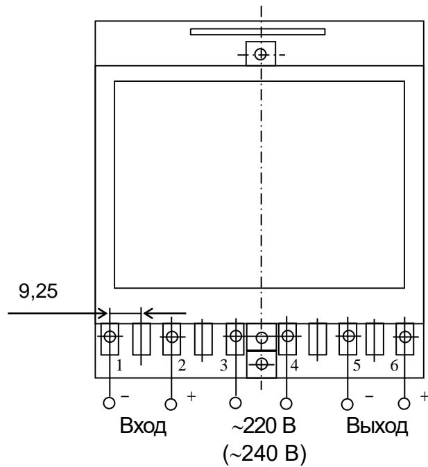
Рисунок А.2 - Вид ИП со снятой крышкой клеммной колодки.
