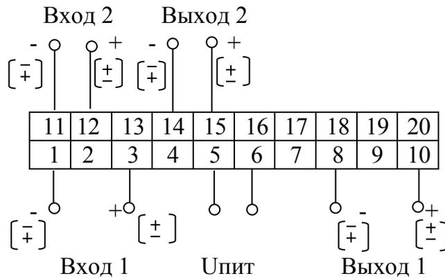
Рисунок А.4 - Схема электрическая подключений двухканальных ИП
