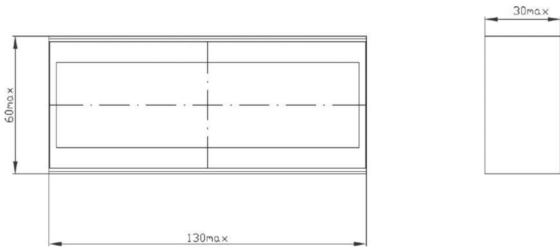
Рисунок А.3 – Габаритные размеры показывающего устройства ПУ-25
