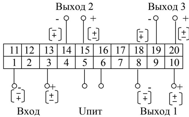
Рисунок А.3 - Схема электрическая подключений одноканальных ИП
