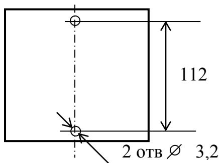
Рисунок А.2 – Установочные размеры ИП
