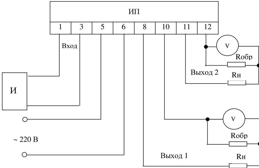
ИП – поверяемый измерительный преобразователь;
