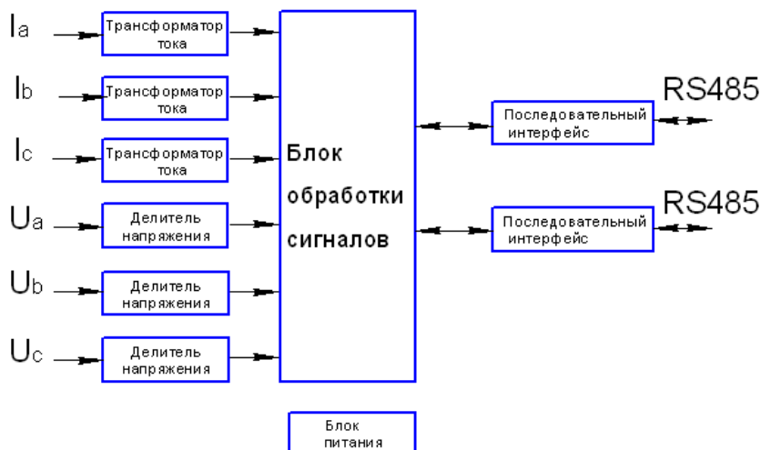
Рисунок 2 – Структурная схема ПИ
