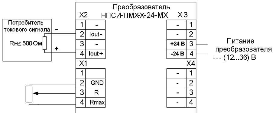
Рисунок 5 – Электрическая схема подключения преобразователя НПСИ-ПМХ-Х-24- МХ
