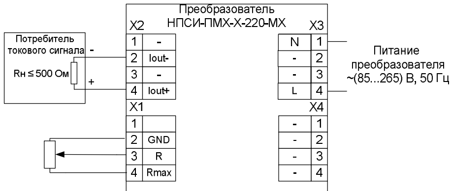
Рисунок 4 – Электрическая схема подключения преобразователя НПСИ-ПМХ-Х-220- МХ
