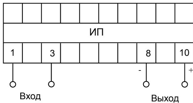
**Рисунок Б.1 – Схема электрическая подключения ИП**
