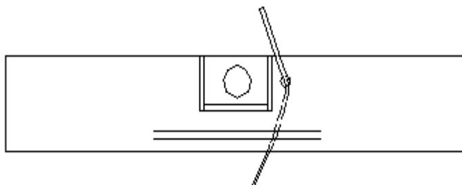
2 Вставить и защелкнуть крышку клеммной колодки
