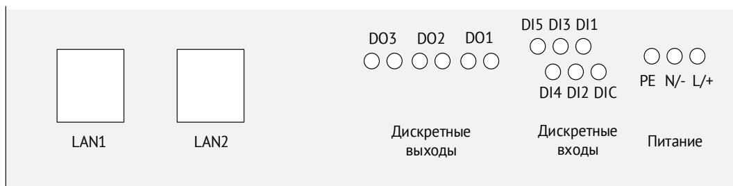
Рисунок 1.15. Расположение клемм и интерфейсов ЭНИП-2-0-...-Х3.
