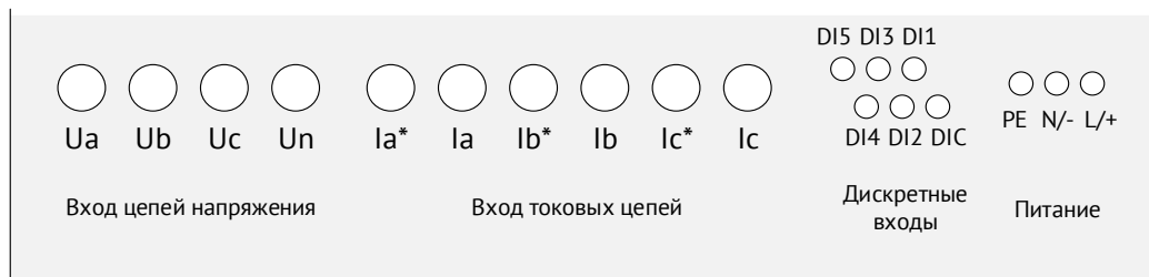
Рисунок 1.14. Расположение клемм ЭНИП-2-...-Х3.
