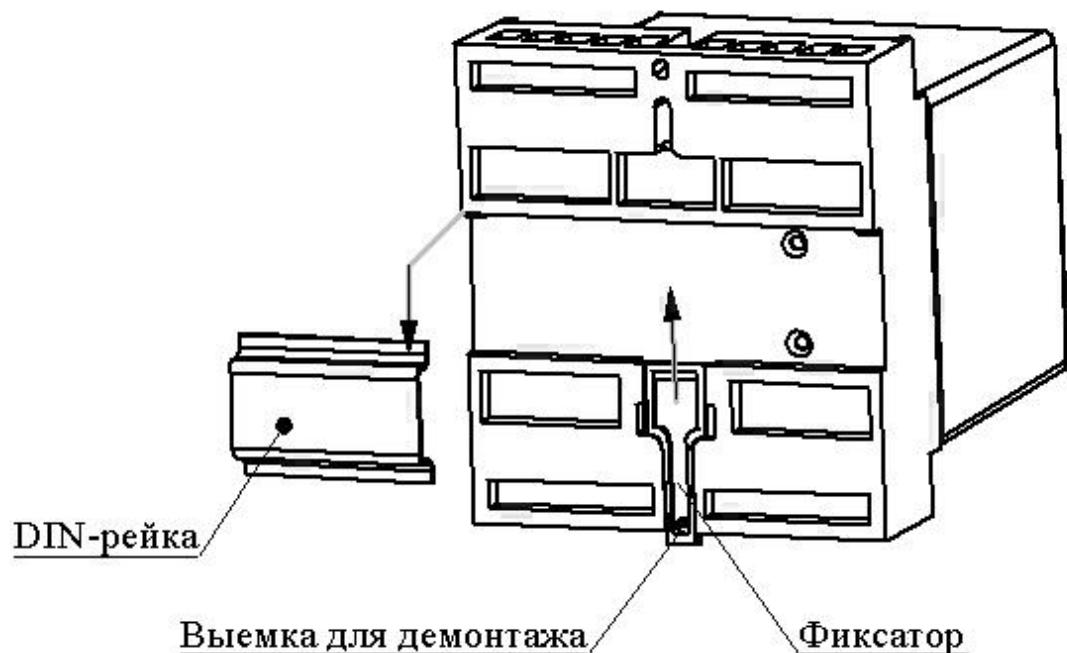
Рисунок А. 2 – Схема установки на DIN-рейку
