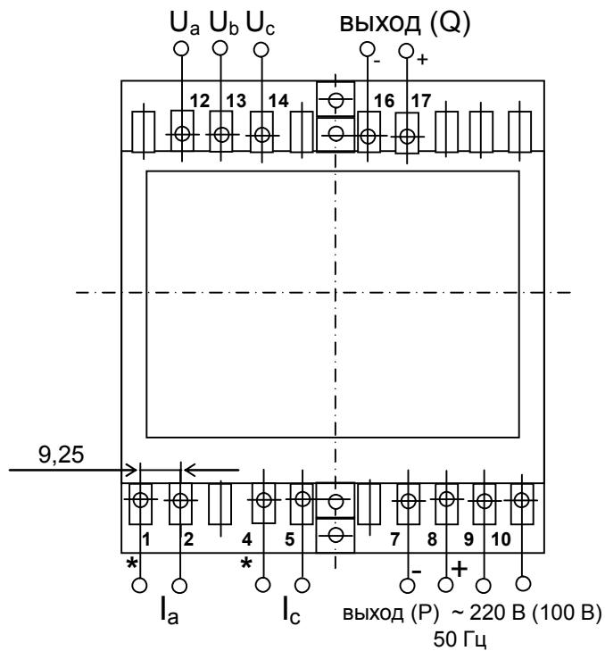
Рисунок А.3- подключение ИП
