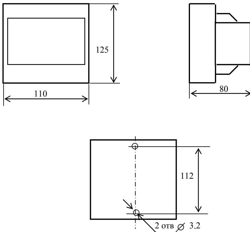
Рисунок А.1 – Габаритные и установочные размеры
