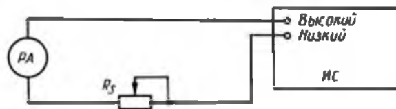
PA — амперметр постоянного тока; R_x — переменное сопротивление; ИС — испытуемый ЦИП; Высокий — импеданс; Низкий — импеданс.
